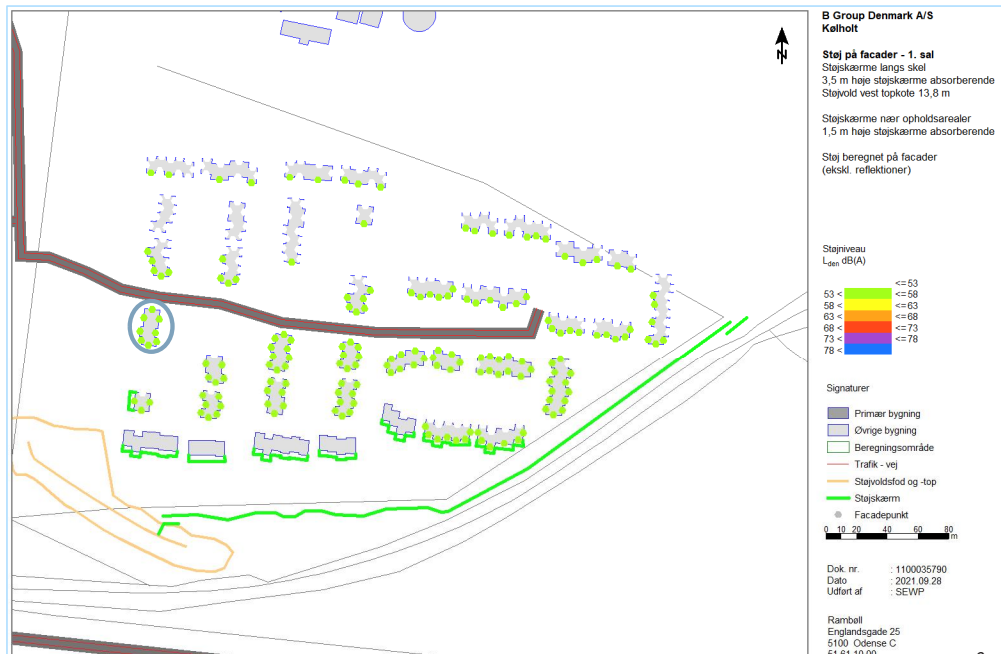
Figur 10 viser: Beregnet facadestøj i 1. sals højde med afskærmning. Bygningen med blå cirkel omkring skal holde en afstand på minimum 6 m fra vejen, for at kunne overholde de vejledende støjkrav. Enkelte bygninger mod syd kan ikke opføres i 1. sals højde, da grænseværdien ellers overskrides.
