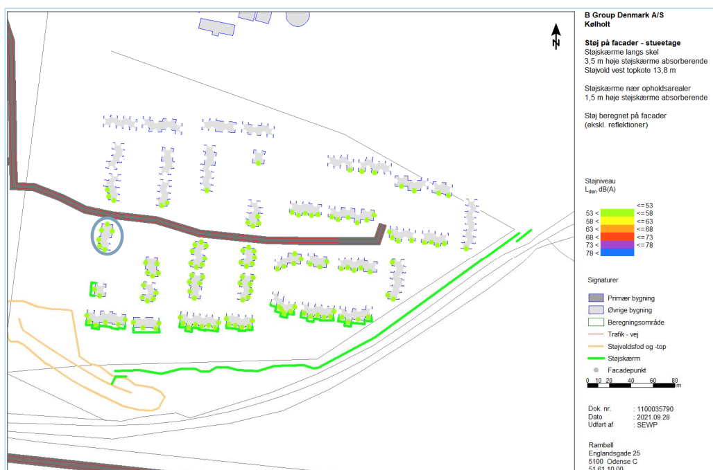
Figur 9 viser: Beregnet facadestøj i stueplan med 1,5 m afskærmning. Bygningen med blå cirkel omkring skal holde en afstand på minimum 6 m fra vejen, for at kunne overholde de vejledende støjkrav.
