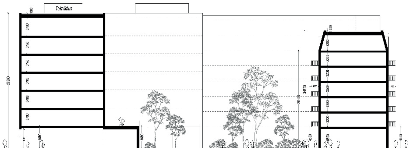
Figur 15.5. Snit C-C igennem karréens gårdrum (ikke målfast). Etablering og udformning af altaner mod vej afhænger af støjforholdene fra vejtrafikken.
